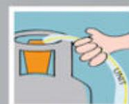
**Controle periódicamente** el estado de los artefactos a GLP, de los tubos flexibles y de las abrazaderas. **Únicamente utilice tubos flexibles certificados** por UNIT para uso de GLP. Estos están debidamente identificados y su vida útil es de 5 años.
